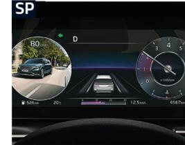
**Monitor de Punto Ciego** - Al activar el giro, el monitor de punto ciego se va a activar en el tablero digital junto a las imágenes de video en vivo de otros vehículos ubicados en el punto ciego del lado del carril al cual quieres dirigirte.
