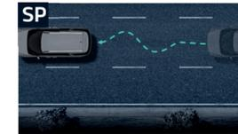
**Sistema de Alerta de Fatiga del Conductor** - El sistema analiza los patrones de conducción del conductor y si hay signos de fatiga del conductor el sistema recomienda una pausa mediante mensajes emergentes mensajes y avisos sonoros.
