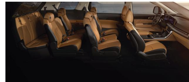
La configuración de los asientos permiten ubicar hasta once personas cómodamente con amplio espacio en su interior. La cuarta fila se puede ocultar debajo del piso de carga y la 3ª fila puede reclinarsse y deslizarse, para lograr una amplia capacidad de carga para transportar objetos a donde los necesites.
